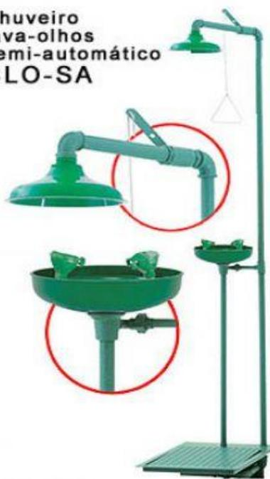
Foto 06 – Modelo de um chuveiro de emergência com lava olhos existente no mercado, onde se detalha o acionamento do chuveiro por alavanca e a entrada de água no lava-olhos, que é acionada pela plataforma. Disponível em Imagens Google, no link: [http://www.pecinox.com.br/img/produtos/gra\\_CLO-SA.jpg](http://www.pecinox.com.br/img/produtos/gra_CLO-SA.jpg). Acesso em 15 de junho de 2015.
