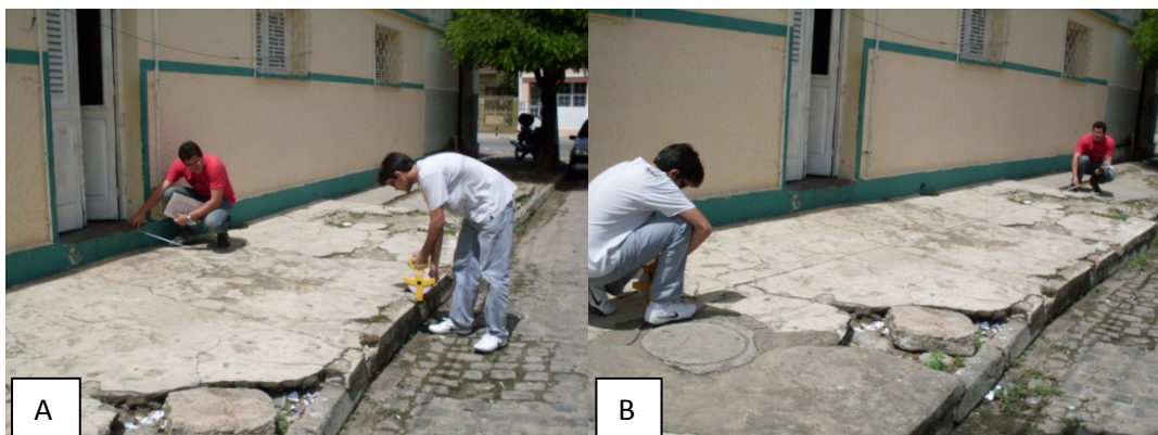
Figura 6. Coletando a metragem da calçada. A- Comprimento; B- Largura
