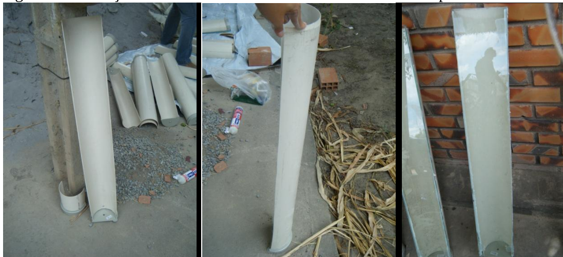
Figura 4 Construção dos rizotrons com tubos de PVC e vidro transparente
