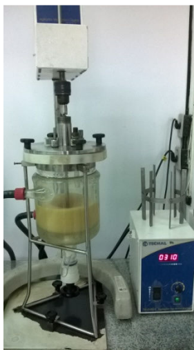
Figura 4 – Reator utilizado para agitação do óleo + glicerina
