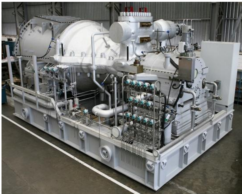
Figura 6: Turbina a vapor
