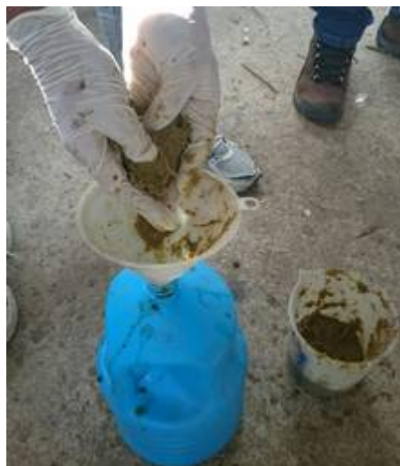
Figura 8. Conteúdo gástrico (fluido ruminal) utilizado como inoculo nos ensaios de batelada.
