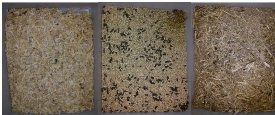
Figura 9. Resíduos utilizados no processo de digestão anaeróbia. (A) Maravalha de pinus + dejetos de animais de laboratório; (B) Maravalha de sabugo de milho + dejetos de animais de laboratório; (C) Maravalha de bagaço de cana-de-açúcar + dejetos de animais de laboratório.
