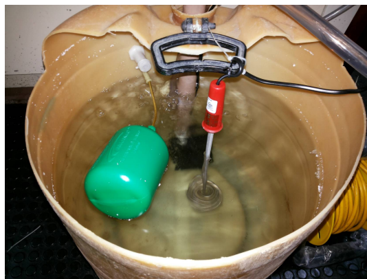
Figura 6. Sistema de aquecimento e recirculação de água para a bancada experimental. Fonte: Dados da pesquisa
