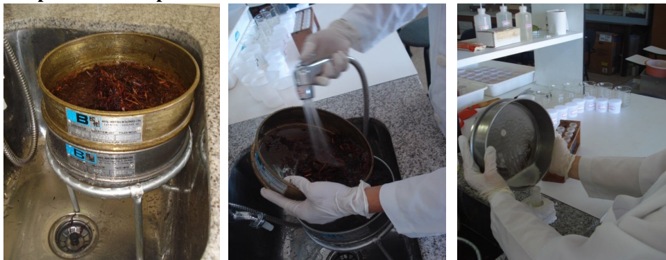
Figura 5 - Processamento de amostras: detalhes da etapa de lavagem das raízes em peneiras sobrepostas de 60 e 400 mesh.
