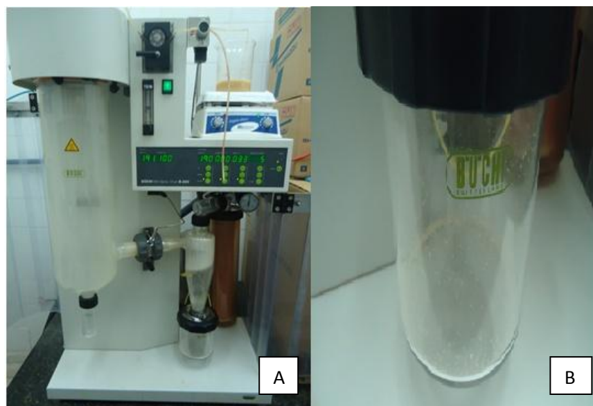
Figura 3: Detalhe do Mini Spray Dryer B-290 (A) e seu recipiente de coleta (B)
