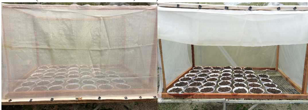
Figura 2: Estrutura de madeira e rede de nylon para proteger as amostras de fontes de contaminações externa. Fonte: Elaborada pelo autor, 2017
