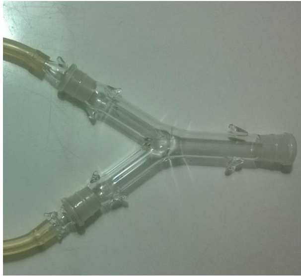
Figura 6 - Olfatômetro de tubo Y utilizado no bioensaio de preferência com Cotesia flavipes .
